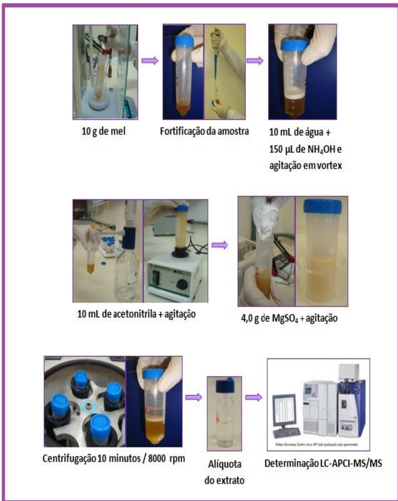
Figura 19 - Esquema representando o método QuEChERS otimizado.
